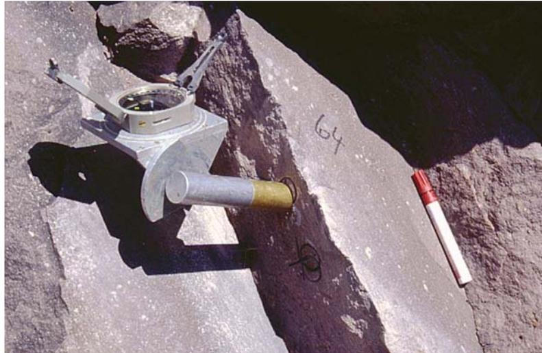
**Abb. 6.1:** Orientierung der Bohrkerne
